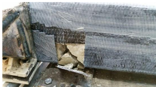
شکل ۸: نمونه تیر بتنی ترمیم شده به روش FRP. پس از بارگذاری کامل و رسیدن به لنگر ترک خوردگی نهایی
