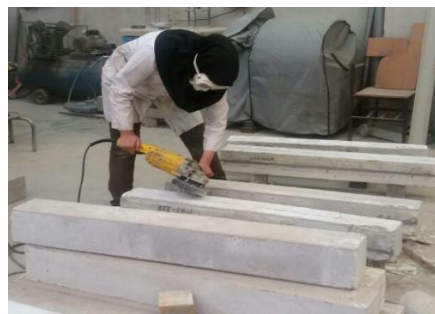
شکل ۲ ساب زدن تیرهای بتنی با دستگاه فرزنسنگ به منظور گرد نمودن گوشه‌ها و از بین بردن پستی و بلندی های احتمالی
