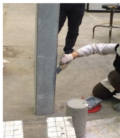
شکل ۳ چسب زدن سطح بتن به منظور چسباندن FRP
