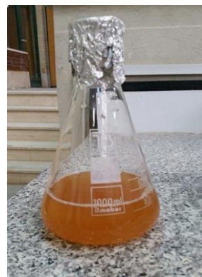
شکل ۷ باکتری آماده شده برای انجام ترمیم بتن به روش تزریق باکتری
