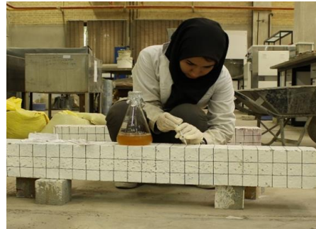
شکل ۱۰- تزریق باکتری به داخل ترک از طریق سرنگ انسولین یافته‌ها
