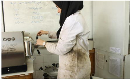
شکل ۳ قرار دادن محیط کشت در اتوکلاو به منظور از بین رفتن میکرب‌های احتمالی
