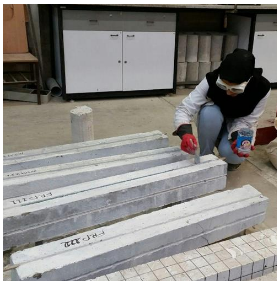
شکل ۶ مدفون کردن میلگردهای GFRP در چسب اپوکسی
