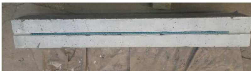
شکل ۵ قرار گرفتن میلگرد GFRP در داخل شیار ایجاد شده بر روی بتن
