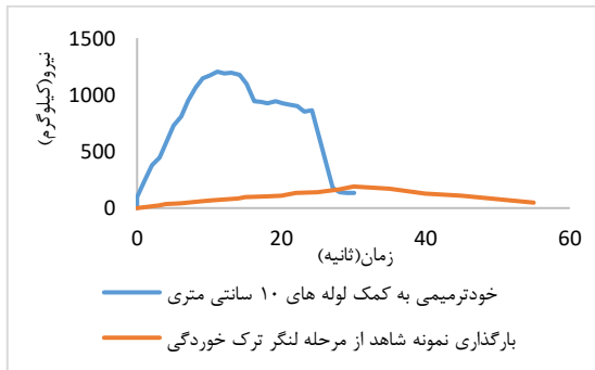
نمودار ۷ نمودار نیرو بر حسب زمان برای نمونه شاهد و نمونه ترمیم شده با روش خودترمیمی با لوله‌های ده سانتی متری
