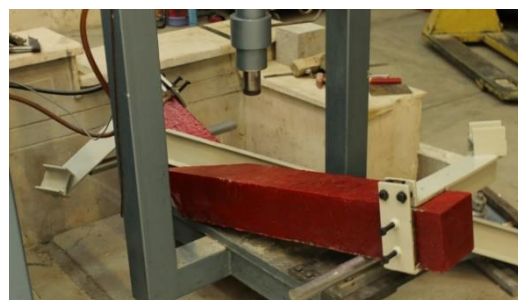
شکل ۹ تیر بتنی فاقد آرمانتور، شکسته شده با زاویه ۴۵ درجه تحت بارگذاری پیچشی
