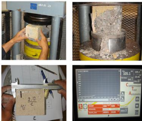
شکل ۶ آزمایش مقاومت فشاری، (الف) قرار دادن نمونه در جک بتن-شکن، (ب) بتن کسته شده، (ج) اندازه‌گیری ابعاد نمونه، (د) مانیتور جک بتن‌شکن در حال بارگذاری
