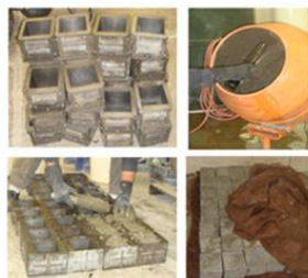
شکل ۴ مراحل ساخت نمونه های بتنی
