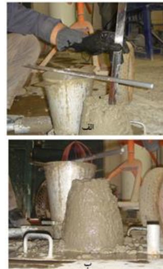
شکل ۵ آزمایش اسلامپ بتن تازه الف) نحوه اندازه‌گیری عدد اسلامپ، ب) قرارگیری اسلامپ در کنار بتن تازه
