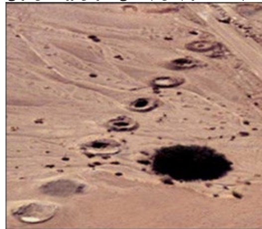
شکل ۵. نحوه‌ی قرارگیری چاه‌های قنات در کنار همدیگر
