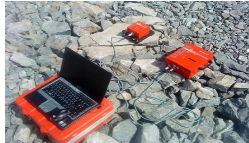
شکل ۳- ابزار MR2002 به منظور ثبت لرزش زمین
