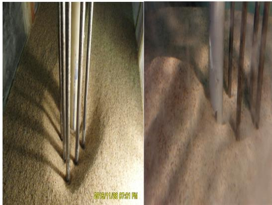
شکل ۵- گودال آبخستگی پس از ۵ ساعت با آرایش ۳۰ درجه و آرایش  $1/d_3$  در راست و با آرایش ۴۵ درجه و فاصله  $d_1$  در چپ
