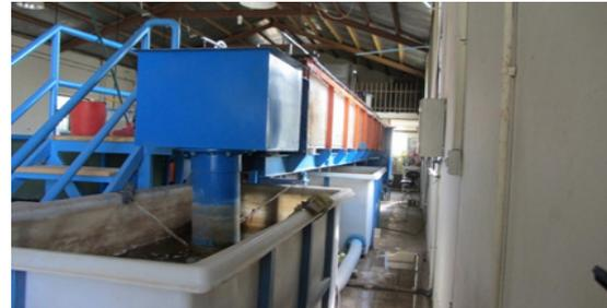
شکل ۲- نمای کانال آزمایشگاهی و مخازن
